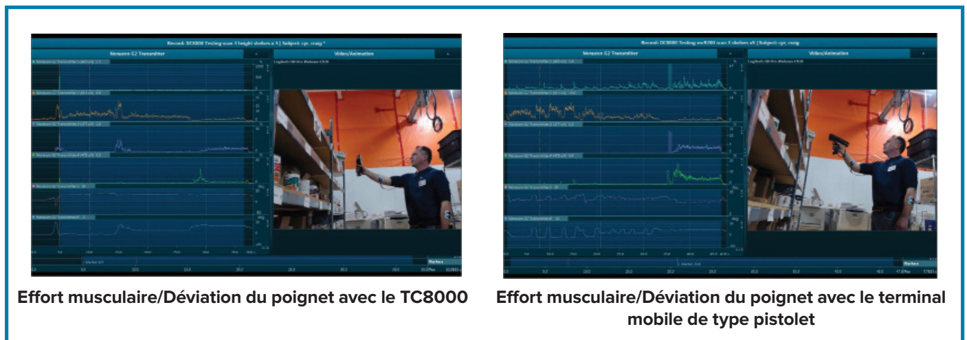
FIGURE 13 : les niveaux présentés dans les images ci-dessus pour l'effort musculaire et la posture du poignet viennent confirmer les résultats obtenus lors de la phase 2. L'amplitude des signaux musculaires et des déviations du poignet enregistrées lors des opérations de lecture et vérification est considérablement réduite, ce qui aboutit à une accélération des tâches.
