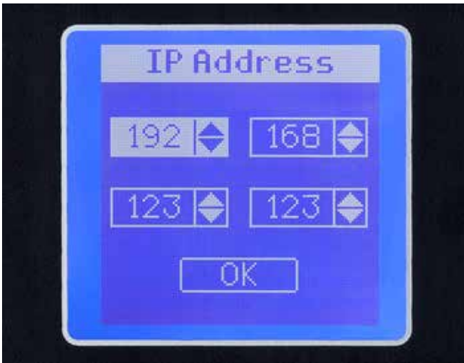
Figure 2. Écran LCD avancé avec options de menu interactif déroulant sur PDU.
