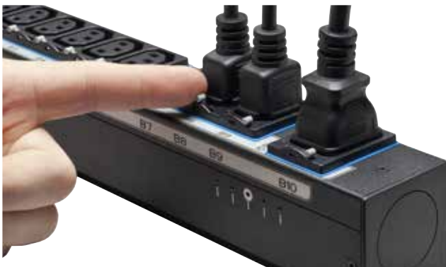
Figure 3. Système anti-arrachement prises IEC permettant une retenue de prise et supprimant le besoin de gestion de câble intrusif qui bloque souvent l'écoulement d'air et réduit la fonctionnalité.
